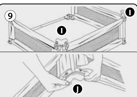
DE: **Wichtig:** für einen sicheren Halt zwingend die Kappen (I) aufstecken und die Sicherung ankleben.
