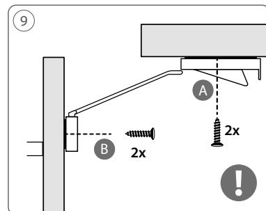
**DE** Verwenden Sie zwingend die beiliegenden Schrauben. Das Klebeband bietet nicht ausreichend Schutz! Zur Demontage die Schrauben lösen und Sicherung entfernen.
