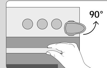
**Backofen-Sicherung entfernen // Remove oven lock // Retirer la sécurité porte de four
